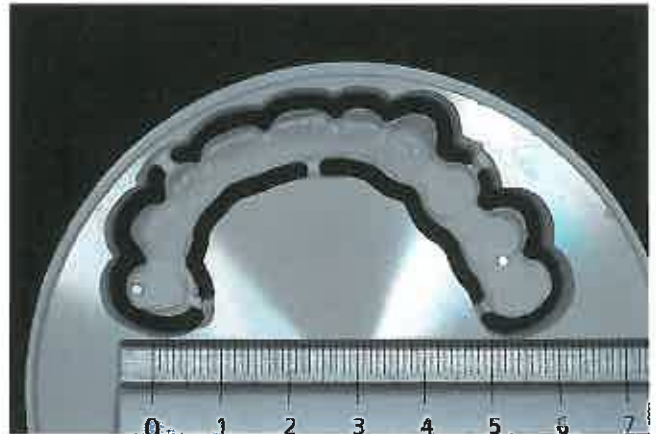
Abb. 9 Das 10-gliedrige Zirkonoxidgerüst vor dem Heraustrennen aus dem Xawex-Rohling in der Grünphase. Während des folgenden Sinterprozesses zum Erreichen der definitiven Form und Endfestigkeit wird das Gerüst um ca. 20 % schrumpfen
