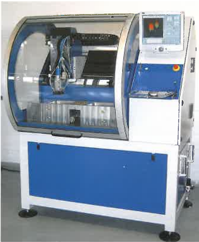
Abb. 2 Die Fräsmaschine i-mes Premium wurde aus einer bewährten Industrie-Fräsmaschine für die speziellen Erfordernisse der Zahnmedizin weiterentwickelt. Neben Xawex-Zirkonoxid kann sie auch viele andere Materialien wie Titan, Nichtedelmetall und Kunststoffe bearbeiten. i-mes liefert außerdem Systeme, die nur Xawex verarbeiten können – diese sind entsprechend günstiger in der Anschaffung
