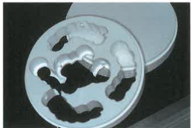
Abb. 1 Der Rohling Xawex G 100 hat einen Durchmesser von 100 mm und besteht aus Zirkonoxid in der Grünphase. In Abhängigkeit von der Größe können bis zu 30 Gerüsteinheiten aus demselben Rohling gefräst werden. Je nach Bedarf stehen unterschiedliche Dicken zur Verfügung
